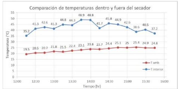
(b) temperatura en el interior y exterior del secador.
